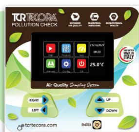
Lo strumento è dotato di display a colori touch screen e di un software dedicato al campionamento ambientale. Permette di visualizzare i parametri del flusso (flusso aria, volume, tempo trascorso, pressione, temperatura, polveri real time (opzionale), velocità e direzione vento (opzionale), real time  $\text{CO}_2$  (opzionale), allarmi e di regolare i parametri di funzionamento tramite un facile sistema di menu a icone.
