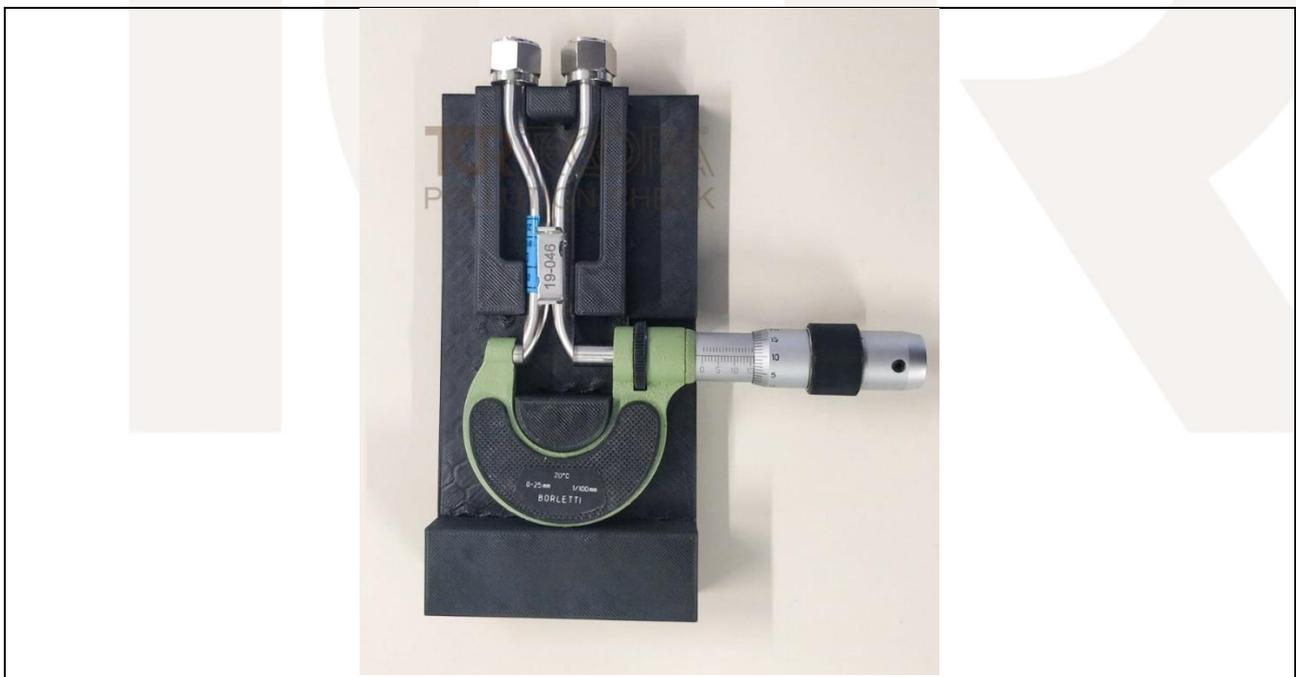
Foto 1: Particolare del posizionamento del Pitot S (n° 19-046) su dima fatta circolare dai partecipanti
